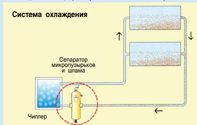
Hi-flow разработан специально для систем со скоростью потока от 1 м/сек до 3 м/сек
