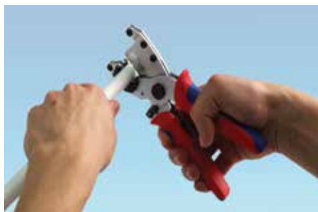
Обрезание трубы при помощи труборезных ножниц
